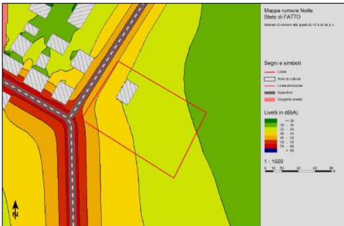
Fig. 10.4 – Estratto della mappa del rumore stato di fatto riferita al periodo notturno. Livelli ad altezza di +2 m da terra.
