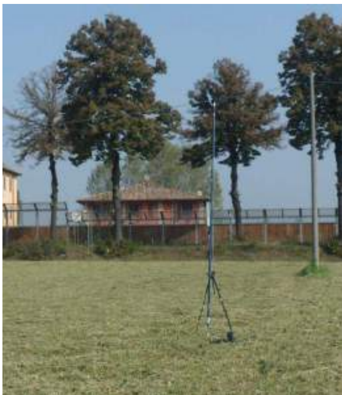
Fig. 5.1 e 5.2 – Ripresa fotografica della strumentazione utilizzata per la misura del rumore ambientale, Fonometro integratore/analizzatore Real Time LARSON DAVIS modello 831. Il microfono è installato su di un cavalletto ed è collegato allo strumento mediante un cavo di prolunga microfonico (foto di repertorio).
