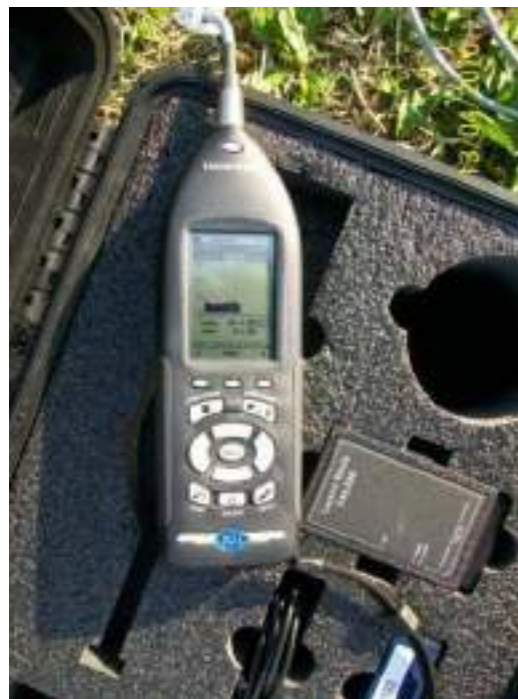
Fig. 5.1 e 5.2 – Ripresa fotografica della strumentazione utilizzata per la misura del rumore ambientale, Fonometro integratore/analizzatore Real Time LARSON DAVIS modello 831. Il microfono è installato su di un cavalletto ed è collegato allo strumento mediante un cavo di prolunga microfonico (foto di repertorio).
